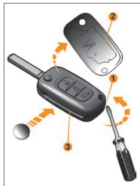
Рис. 9. Замена элемента питания пульта дистанционного управления
