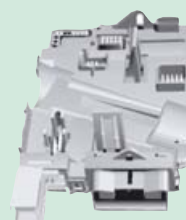
J527 – блок управления приборами на рулевой колонке
