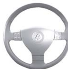
J453 – блок управления приборами на многофункциональном рулевом колесе
