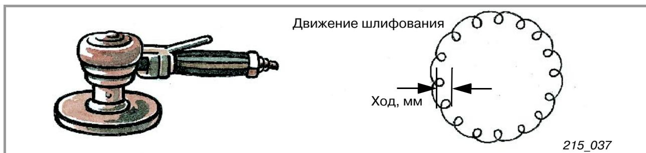
Шлифовальная машинка с вращательно-колебательным движением
